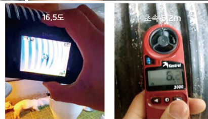
(사진 2) 겨울철 자돈사 내부 입기 공기 온도(16.5℃) 및 입기 속도(초속 6.2m)
