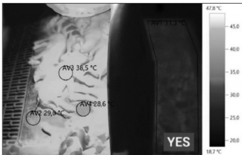
(그림 9) 동일한 보온 공간 내에서도 보온통과의 거리에 따라 바닥의 표면 위치가 다르게 나타난다. 보온 공간의 온도가 의도한 바와 같이 고르게 유지되도록 보온통이 설정되어 있는지 점검이 필요하다.
